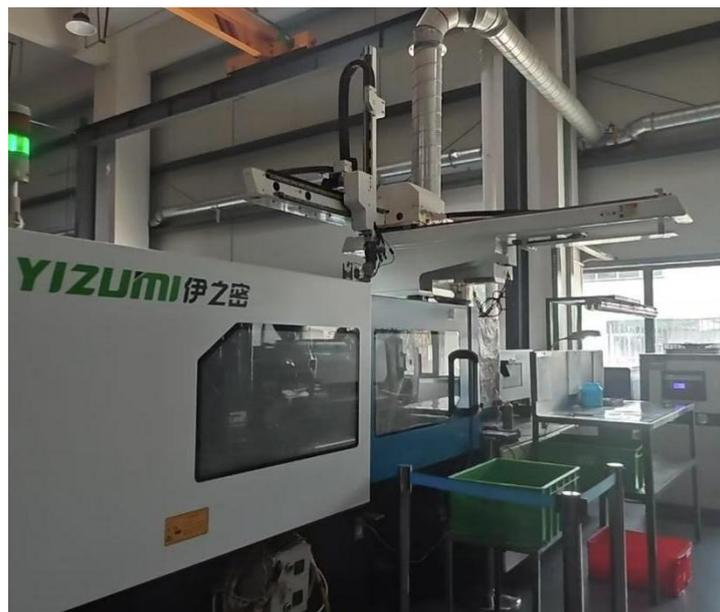
干燥废气、注塑废气收集
